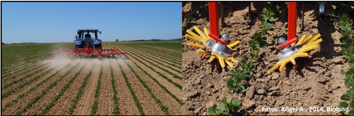
Abb. 1 Bild links: Striegeleinsatz im Sojabestand, Bild rechts: Hackgerät in Kombination mit Fingerhacke
