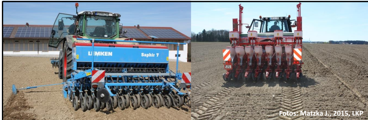
Abb. 1 Mit Drillsaat (links) und Einzelkornsaat (rechts) die am häufigsten eingesetzte Sätechnik bei Sojabohnen
