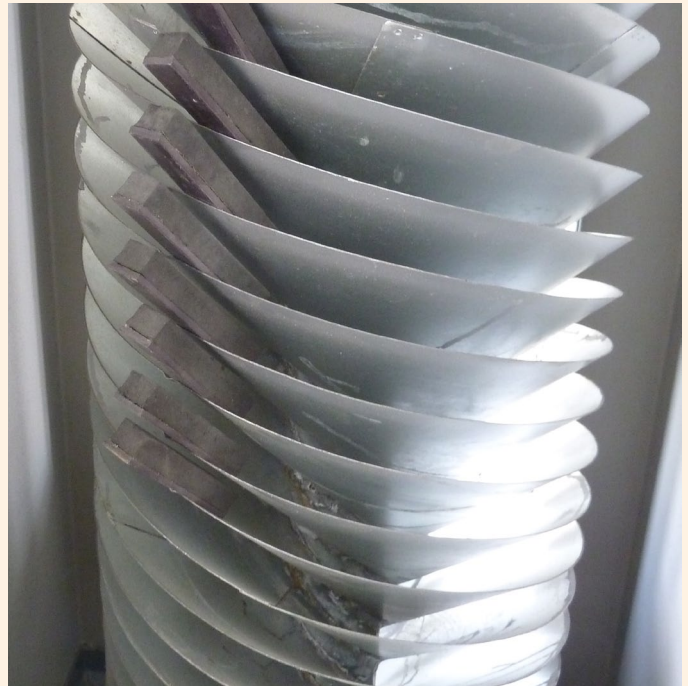
Abbildung 3: Fingerbremsen zum Abbremsen des Gutstroms auf gleicher Ebene in allen acht Spiralen.
