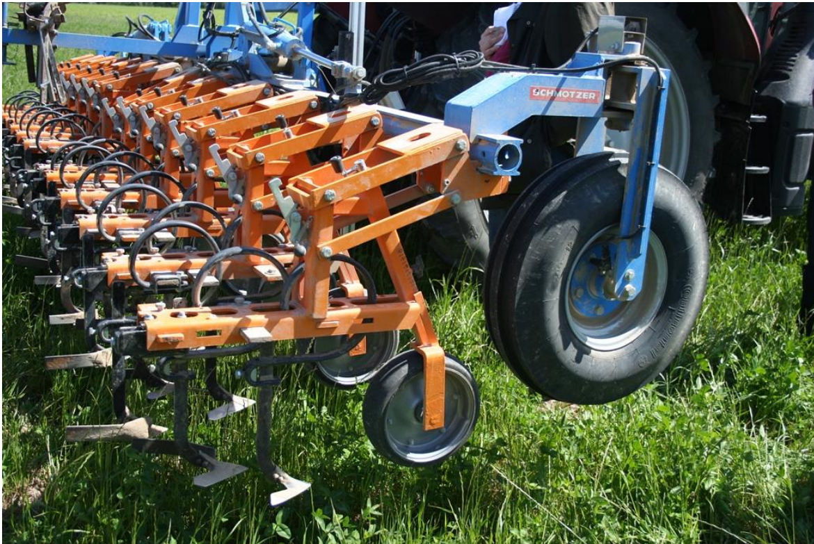
Abb.5: Die kameragesteuerte Scharhacke der Fa. Schmotzer arbeitet sehr nah und präzise an die Pflanzenreihe heran.
