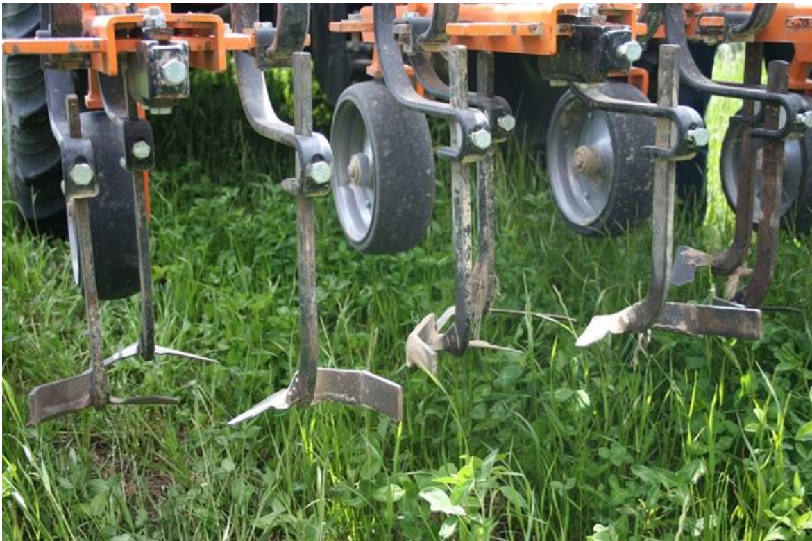
Abb.6: die Schare sind mit aufgeschweißten Häufelblechen versehen um Erde in die Pflanzenreihe zu bewegen
