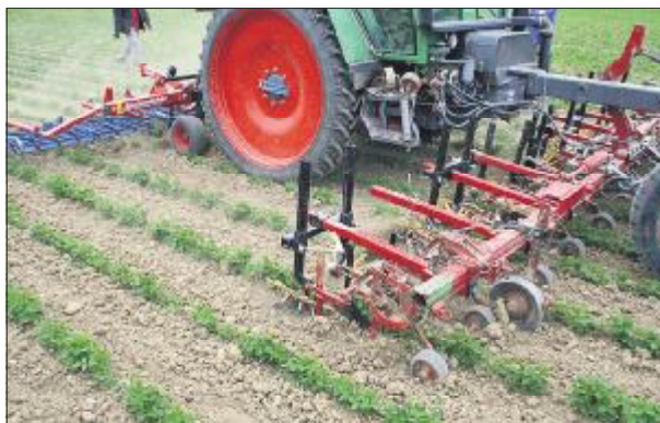
Vielfach kommt noch der Zwischenachs-Anbau zum Einsatz. Hier wird zusätzlich ein Striegel im Heck mitgeführt, der je nach Bedarf herabgelassen werden kann.
