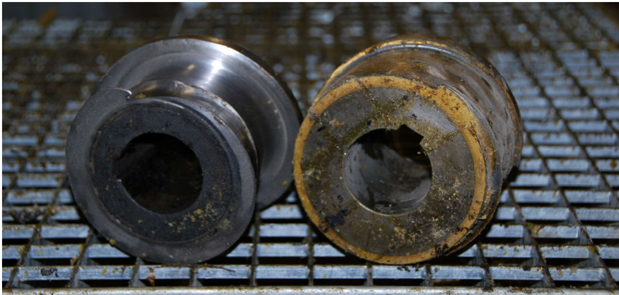
Abbildung 3: Verschlissenes Schneckenpress-Element im Vergleich zu einem gepanzerten Ersatzelement Spaltangaben (Quelle L. Asam, FiBL Deutschland e.V.).
