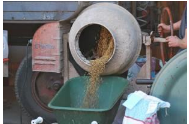
Bild 2: Einmischen des „formulierten“ Hi-Stick – Impfstoffes mit der Betonmaschine
