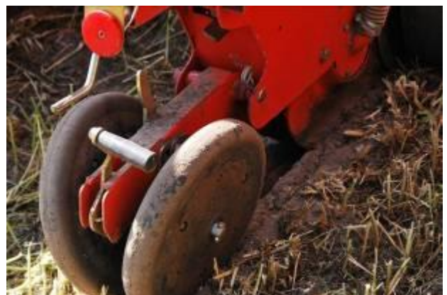
Bild 4: Aufschlitzen, unmittelbare Ablage des Sojasaatgutes und Rückverfestigung der Saattrille
