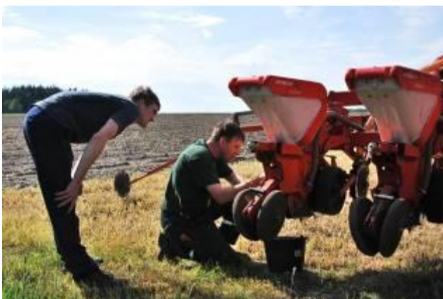
Bild 3: Einstellen und Abdrehen der Einzelkornsämaschine
