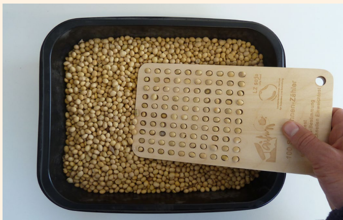
Abbildung 2: Den größten Aufwand stellt beim Einweichtest das Abzählen der 100 Bohnen dar. Abhilfe schafft ein einfacher Bohnenzähler.
